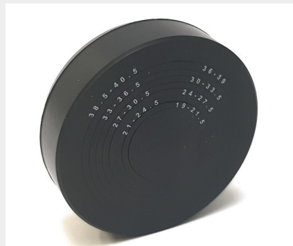
Bild 2: Segmentdichtung, durch Heraustrennen der Segmente kann jeder Leitungsdurchmesser im angegebenen Bereich abgedichtet werden
